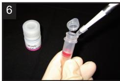
6 WS Buffer 100 μl を Filtration Tube に入れ、8,000 x g で 15 分間遠心する<sup>b)</sup>。遠心後、ろ液を捨てる。
