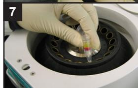
WS Buffer 200 µl を Filtration Tube に入れ、8,000 x g で 10 分間遠心する<sup>b)</sup>。この操作をもう一度繰り返す。
