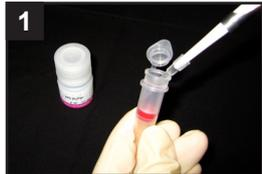
IgG 50 ~ 200 µg を含むサンプル溶液と WS Buffer 100 µg を Filtration Tube に加える<sup>a)</sup>。
