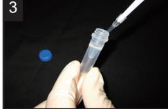
3 NH<sub>2</sub>-Reactive ICG に 10  $\mu$ l の DMSO を加え、ピペティングにより溶解する<sup>c)</sup>。
