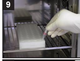
ピペッティングによりメンブレン上の還元 IgG と混合した後、37°C で 1 時間反応する。
