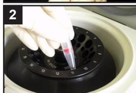
2 ピペッティングにより軽く混合した後、8,000 x g で 10 分間遠心する<sup>b)</sup>。
