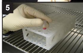
ピペティングによりメンブレン上のタンパク質と混合した後、37°C で 10 分間反応させる。
