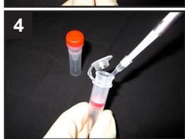
操作 3 の溶液 100 µl を IgG が濃縮されている Filtration Tube のメンブレン上加える。
