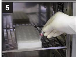
ピペッティングによりメンブレン上の IgG と混合した後、37°C で 30 分間反応する。
