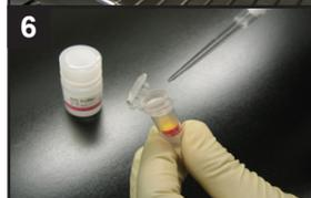
WS Buffer 100 µl を Filtration Tube に入れ、8,000 x g で 10 分間遠心する<sup>b)</sup>。遠心後、ろ液を捨てる。
