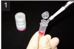
1 タンパク質 50 ~ 200  $\mu$ g を含むサンプル溶液と WS Buffer 100  $\mu$ l を Filtration Tube に入れ、ピペティングにより軽く混合する<sup>a)</sup>。
