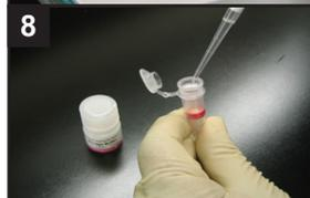
WS Buffer 200 µl を Filtration Tube に入れ、10 回程度ピペティングし、標識体を回収する<sup>e)</sup>。マイクロチューブに移し、0 ~ 5°C で保存する。
