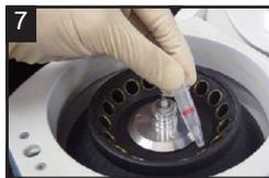
7 WS Buffer 200 μl を Filtration Tube に入れ、8,000 x g で 15 分間遠心する<sup>b)</sup>。この操作をもう一度繰り返す。
