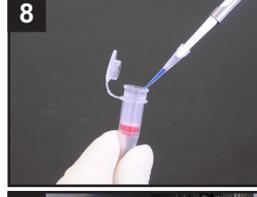
操作 7 の溶液を還元 IgG が濃縮されている Filtration Tube のメンブレン上加える。
