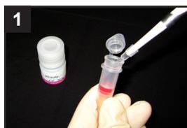
1 IgG 50 ~ 200 µg を含むサンプル溶液<sup>a)</sup>と WS Buffer 100 µl を Filtration Tube に加える。
