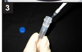
NH<sub>2</sub>-Reactive Fluorescent Dye に 10 µl の DMSO を加え、ピペティングにより溶解する<sup>c)</sup>。
