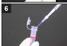
6 NH<sub>2</sub>-Reactive Phycobiliprotein を含む溶液を IgG が濃縮されている Filtration Tube のメンブレン上加える。
