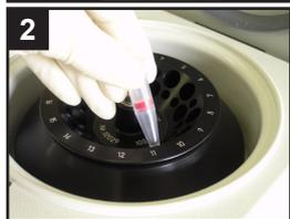
ピペッティングにより軽く混合した後、8,000 x g で 10 分間遠心する<sup>b)</sup>。
