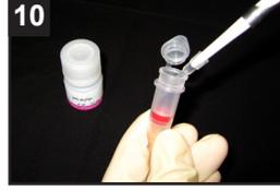
WS Buffer 150 µl を加え、10 回程度ピペッティングし、標識体を回収する<sup>d)</sup>。溶液をマイクロチューブに移し、0 ~ 5°Cで保存する<sup>e)</sup>。
