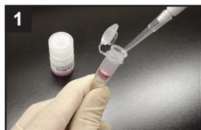
タンパク質 50 ~ 200 µg を含むサンプル溶液と WS Buffer 100 µl を Filtration Tube に入れ、ピペティングにより軽く混合する<sup>a)</sup>。
