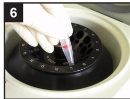
RA Solution 100 µl を加え、8,000 x g で 10 分間遠心する<sup>b)</sup>。ろ液を捨てた後、RA Solution 200 µl を加え、さらに遠心する<sup>b)</sup>。
