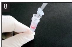
8 PBS 200 μl を Filtration Tube に入れ、10 回程度ピペッティングし、標識体を回収する<sup>e)</sup>。マイクロチューブに移し、0 ~ 5°C で保存する。
