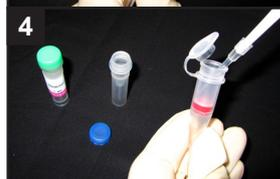
Reaction Buffer 100 µl を加えた後、NH<sub>2</sub>-Reactive Fluorescent Dye を含む DMSO 溶液 8 µl<sup>d)</sup> を Filtration Tube のメンブレン上に加える。
