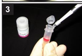
3 WS Buffer 100µl を Filtration Tube に加える。
