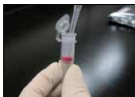
2) TE-buffer を添加後、溶液を Filtration tube に入れ、遠心分離する。これを繰り返し行い、ARP 標識 DNA を精製する。
