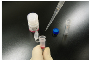
操作 5. ろ液を捨てた後、Washing Buffer 200 µl を加える。
