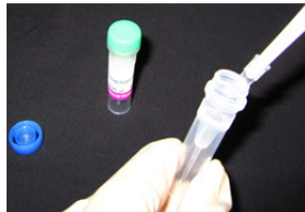
操作 1. Reaction Buffer で調製した 1 mmol/l サンプル溶液 50 µl を、NH 2 -Reactive Alkaline Phosphatase に加える。
