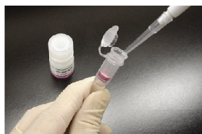
操作 1. IgG 50 ~ 200 µg を含むサンプル溶液 a) と Washing Buffer 100 µl を Filtration Tube に加える。
