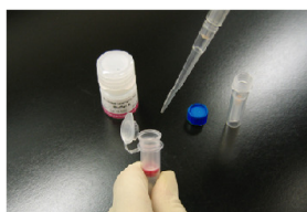
操作 5. 溶液を捨てた後、Solution A 200 µl を加える。
