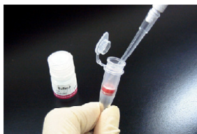
操作 10. Solution A 100 µl を Filtration Tube に加える。
