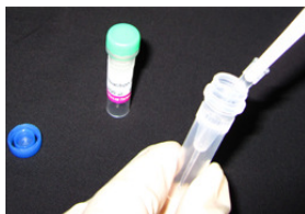
操作 1. Reaction Buffer で調製した 1 mmol/l サンプル溶液 a) 50 µl を、SH-Reactive Peroxidase に加える。
