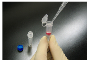
操作 8. SH-Reactive Peroxidase を含む溶液を還元 IgG が濃縮されている Filtration Tube のメンブレン上加える。
