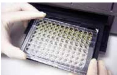
6)-7) 37°Cで10分間インキュベート後、マイクロプレートリーダーで各ウェルの吸光度を測定する。
