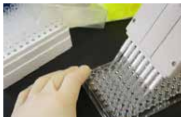
4)-5) Substrate working solution, Enzyme/coenzyme working solution を各ウェルに加える。
