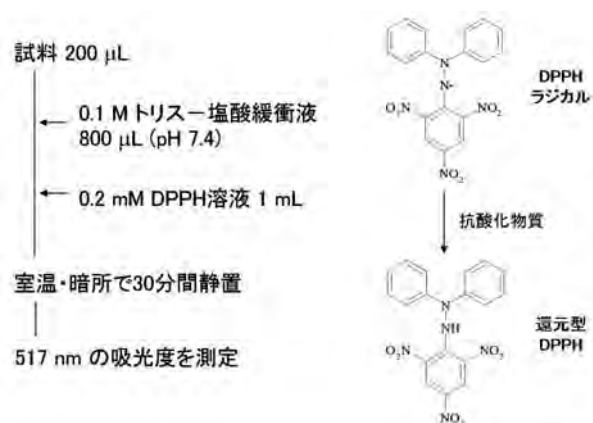
図1 DPPH法原理と室間共同試験に用いた測定手順
