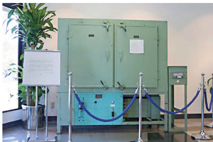
昭和35年に初めて同仁化学研究所に導入された低温乾燥機。 社内にて装置設計を行ったもので、これまでキレート試薬を始めとする製品の生産に 長年、使用されてきた。現在は、その仕事を終え同仁化学研究所の歴史を支えてきた ものとして、玄関ホールに展示されている。
