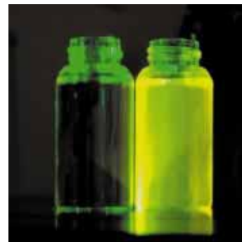
Fig. 2 Spy-LHP (左) 及びその酸化体 (右) の蛍光変化写真
