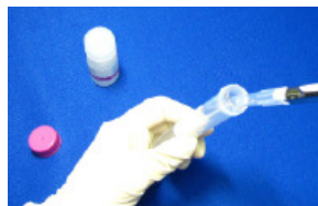
操作 8. Washing Buffer 1 ml を Filtration Tube に加える。ろ液が 4 ml 以上の場合、操作 9 の前にろ液を捨てる。
