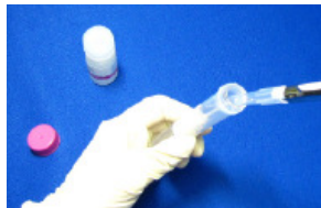
操作 1. IgG 1 mg を含むサンプル溶液 a) と Washing Buffer 1 ml を Filtration Tube に加える。15 ml Tube を用意する b) 。
