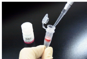
操作 1. IgG 50 ~ 200 µg を含むサンプル溶液 b) と Solution A 100 µl を Filtration Tube に加える。
