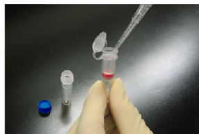
操作 6. NH 2 -Reactive Peroxidase を含む溶液を IgG が濃縮されている Filtration Tube のメンブラン上に加える。
