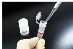
操作 10. Storage Buffer 200 µl を加えて、10 回程度ビベットングし、標識体を回収する d) 。マイクロチューブに移し、0 ~ 5°C で保存する e) 。
