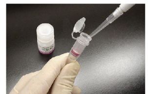
操作 8. Washing Buffer 100 µl を Filtration Tube に加える。
