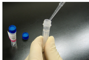
操作 5. Reaction Buffer 10 µl を NH 2 -Reactive Peroxidase に加え、ビベットングにより溶解する c) 。
