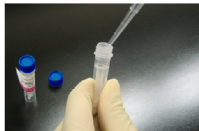
操作 1. Reaction Buffer で調製した 1 mmol/l サンプル溶液 50 µl を、NH 2 -Reactive Peroxidase に加える。
