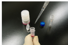
操作 3. Washing Buffer 100 µl を反応溶液に加え、この溶液を Filtration Tube に移す。
