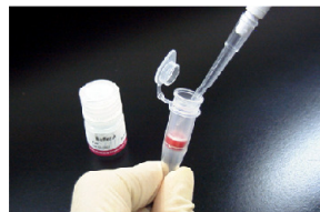
操作 7. Storage Buffer 200 µl を加えて、10 回程度ビベットングし、標識体を回収する d) 。マイクロチューブに移し、0 ~ 5°C で保存する。
