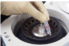
操作 6. 8,000 × g で 10 分間遠心する b) 。再度、Washing Buffer 200 µl を加えて、8,000 × g で 10 分間遠心する b) 。
