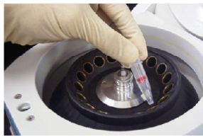
操作 2. ビベットングにより軽く混合した後、8,000 × g で 10 分間遠心する b) 。
