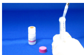
操作 10. Storage Buffer 2 ml を加えて、10 ~ 15 回ビベットングし、標識体を回収する e) 。用意したチューブに移し、0 ~ 5°C で保存する f) 。
