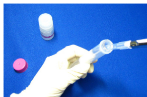
操作 1. IgG 1 mg を含むサンプル溶液 a) と Washing Buffer 1 ml を Filtration Tube に加える。15 ml Tube を用意する b) 。
