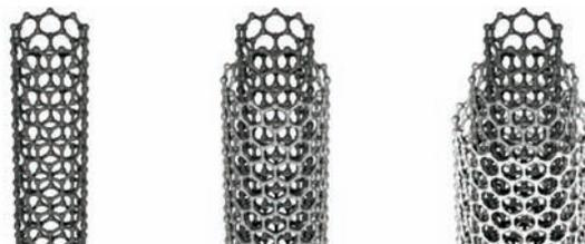
図2 CNTの構造
